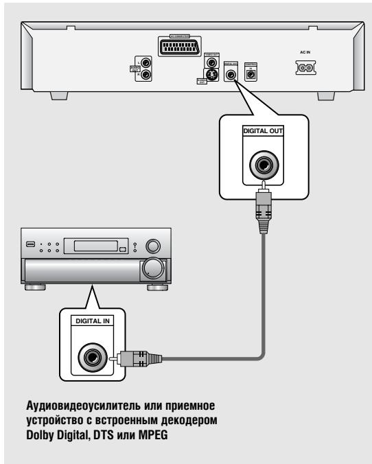
Аудиовидеоусилитель или приемное устройство с встроенным декодером Dolby Digital, DTS или MPEG
