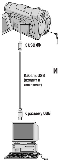
[А] Использование соединительных кабелей USB (Только GR-D50/D40)
