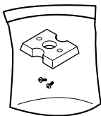
Монтажный переходник Винт (2) Контактная колодка
