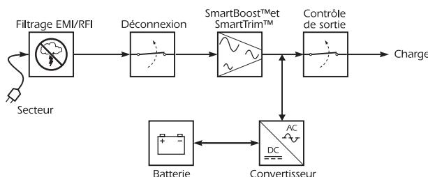
Cet onduleur fournit à votre ordinateur et à vos périphériques un courant électrique alternatif, sans parasites et sans interruption, et protège votre équipement contre les coupures de courant, les baisses de tension, les perturbations de courant, les surtensions et les interférences.
