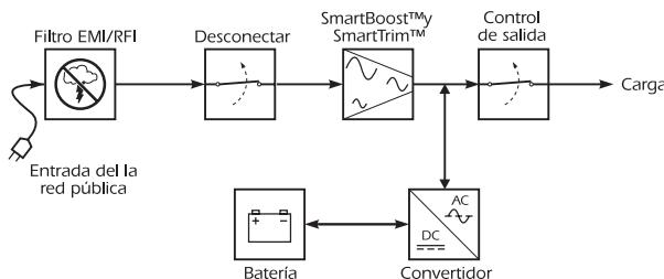
Este sistema de alimentación ininterrumpida (SAI) de alto rendimiento, interactivo en línea, proporciona energía en corriente alterna (CA), limpia y fiable, a los sistemas de informáticos — protegiéndolos de los apagones totales o parciales, alzas y bajas de voltaje, sobrevoltajes transitorios e interferencias.
