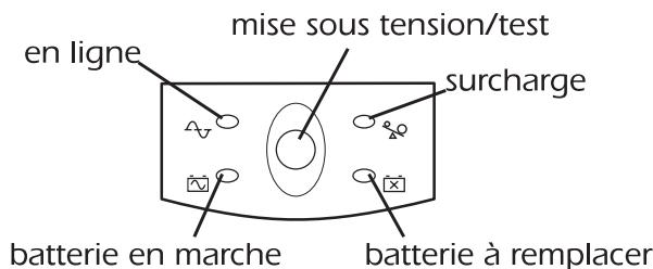
Appuyez sur le bouton de **mise sous tension et de test** allume ou éteint l'onduleur lorsque celui-ci est branché. Voir la section 5.1. Ce bouton déclenche également la **procédure de test automatique** de l'onduleur. Voir la section 5.2.
