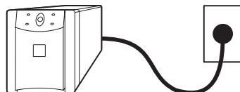
Enchufe el SAI en un receptáculo puesto en tierra de dos polos y tres cables solamente. Evite usar cables de extensión y adaptadores de enchufe.
