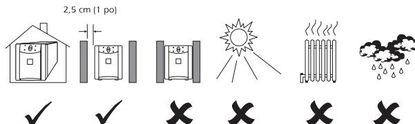
Installez l'onduleur à l'abri des poussières et dans un local bien ventilé. Ne le faites pas fonctionner si la température et l'humidité ambiante dépassent les limites spécifiées (voir le chapitre 12). Attendez que l'onduleur se trouve à la température ambiante avant de continuer.
