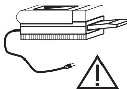
**Precaución:** No conecte una impresora láser al SAI junto con otro equipo de computación a menos que el SAI sea 1400 VA nominal. Una impresora láser periódicamente usa bastante más energía que cuando está inactiva y puede sobrecargar al SAI. Verifique que el SAI puede soportar las cargas cuando la impresora esté en plena operación (imprimiendo).
