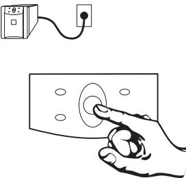
Servez-vous de ce test pour vérifier le bon fonctionnement de l'onduleur et l'état de la batterie. Pour activer la procédure de test, appuyez sur le bouton de mise sous tension et de test, et **main-tenez-le enfoncé** pendant au moins 4 secondes lorsque que l'onduleur est branché au secteur et sous tension. Le voyant de marche se met alors à clignoter.
