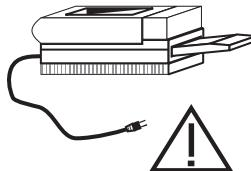
**Attention:** ne branchez pas d'imprimante à laser sur l'onduleur avec d'autres équipements informatiques, sauf si l'onduleur est classé 1 400 VA. Les imprimantes à laser consomment beaucoup plus de courant lorsqu'elles fonctionnent que lorsqu'elles sont à l'arrêt et peuvent provoquer une surcharge de l'onduleur. Vérifiez que ce dernier peut supporter le courant de charge nécessaire lorsque l'imprimante est en train d'imprimer.
