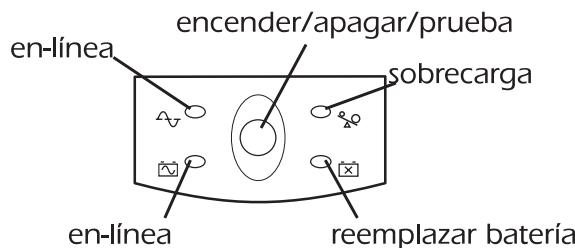
Con el SAI enchufado, presione el botón **encender/apagar/prueba** para encender o apagar el SAI. Vea la Sección 5.1. El botón **encender/apagar/prueba** también activa la prueba automática del SAI. Vea la sección 5.2.
