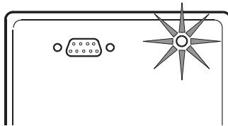
Después de enchufar las cargas y el SAI, verifique el indicador de fallos de cableado en el panel posterior. Vea la sección 3.2 para conocer la ubicación del indicador en el panel posterior. Este se ilumina si el SAI está enchufado en un receptáculo de energía en CA que no esté correctamente cableado. Los fallos de cableado que se detectan incluyen falta de tierra, reversión de polaridad activo-neutro y circuito neutro sobrecargado.
