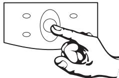
Con el SAI enchufado, presione el botón de encender/apagar/prueba para suministrar energía a las cargas. Las cargas reciben energía de inmediato y el SAI emite unos sonidos y realiza una prueba automática. Vea la sección 5.2. Para apagar la energía a las cargas presione el botón nuevamente. Puede ser conveniente usar el SAI como un interruptor maestro de encender/apagar para el equipo protegido.
