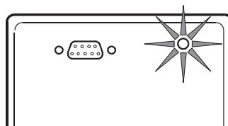
Une fois le circuit de charge et l'onduleur branchés, vérifiez le voyant de défaut de câblage de site situé sur le panneau arrière. Voir la section 3.2 pour le localiser. Il s'allume lorsque l'onduleur est branché sur une prise de secteur mal câblée. Les défauts de câblage détectés comprennent absence de mise à la terre, polarité inversée et circuit neutre surchargé.
