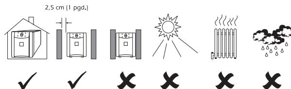
Instale el SAI en un área protegida con adecuado flujo de aire y libre de excesivo polvo. No opere el SAI donde la temperatura y humedad estén fuera de los límites especificados. Vea la sección 12. Permita que el SAI alcance la temperatura ambiente antes de continuar.
