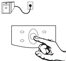
Use la prueba automática para verificar tanto el funcionamiento del SAI como la condición de la batería. Con el SAI enchufado a la red eléctrica normal y encendido, active la prueba automática presionando **y sosteniendo** el botón de encender/apagar/prueba hasta que el indicador en-línea se encienda de forma intermitente. Esto lleva unos 4 segundos.
