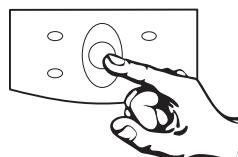
Pour alimenter le circuit de charge, appuyez sur l'interrupteur de mise sous tension et de test. L'onduleur émet un signal sonore et procède à un test automatique de vérification de son fonctionnement. Voir la section 5.2. Pour arrêter l'alimentation du circuit de charge, appuyez sur le bouton
