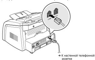
2 Для подключения телефона или автоответчика подключите кабель от телефона или автоответчика к разъему ЕХТ устройства.
