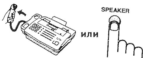
Поднимите трубку или нажмите на кнопку **SPEAKER**. Дождитесь непрерывного сигнала.
