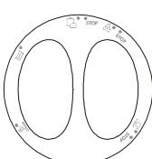
Когда ручка выбора программ остановит свой ход и указатель совпадет со знаком STOP (см. рисунок), цикл мойки будет закончен. Выключите машину при помощи кнопки ON/OFF, закройте кран подачи воды и откройте дверцу. Подождите несколько минут, так как сразу после мойки посуда остается горячей и может легко разбиться. Кроме того, она быстрее высохнет.
