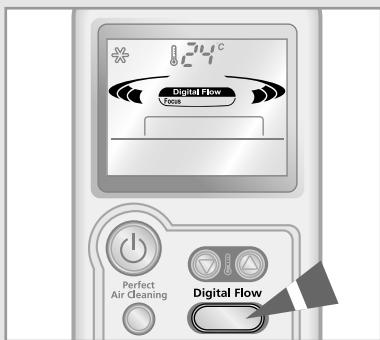
*В режиме Охлаждение, Обогрев, Турбо или Здоровье вы можете отрегулировать цифровой поток в зависимости от ваших потребностей.*
