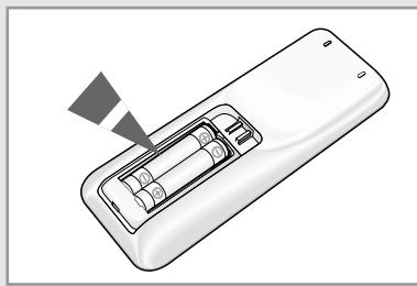
**1** Толкните крышку отсека для батареи на нижней поверхности пульта большим пальцем в направлении, указанном стрелкой и снимите ее.
