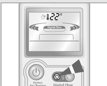
*Если воздух в вашей комнате очень влажный или сырой, вы можете устраниить избыточную влажность воздуха без значительного понижения температуры. При режиме СУШКА, количество воздуха и направление воздушного потока регулируются автоматически.*
