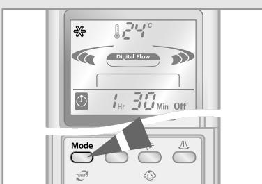
**Таймер включения позволяет автоматически включить кондиционер через определенный промежуток времени. Вы можете установить значение этого промежутка равным от 30 минут до 24 часов. Вы можете выбрать функцию Таймер Вкл только когда кондиционер выключен.**
