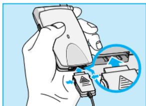
1. Вставьте штекер переносного зарядного устройства в специальное отверстие в нижней части телефона.
