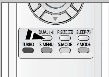
С помощью кнопки "DUAL I-II" осуществляется вывод на экран индикации и выполняется выбор режима обработки и вывода на громкоговорители звукового сигнала. При включении питания телевизора автоматически устанавливается либо режим "Dual-I", либо режим "СТЕРЕО" в зависимости от принятого в данный момент сигнала.
