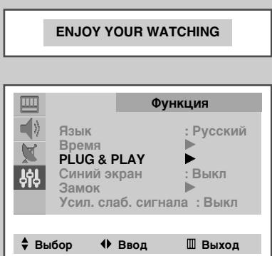
При первом включении питания телевизора автоматически последовательно выполняются три основные установки пользователя: установка языка, сохранение в памяти каналов и установка часов.
