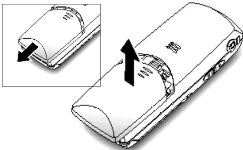
2. Remova a bateria antiga (caso exista), em seguida, ligue o conector da bateria à tomada abaixo ilustrada e introduza a bateria.
